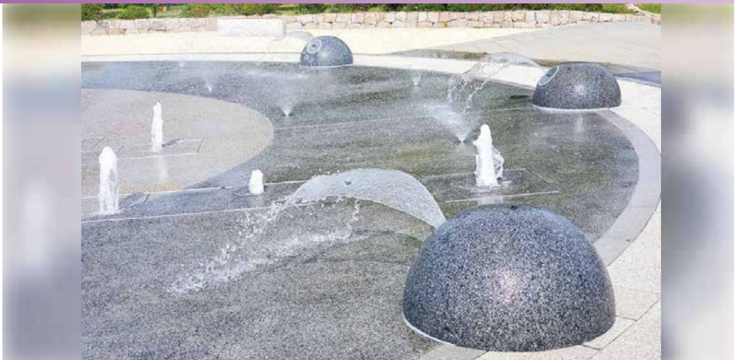
△ 噴水を設計施工。直上噴水・噴霧噴水・石からの扇型噴水と、バラエティのある噴水広場となっている。直上噴水は空気の泡を含んだエアフォーム噴水となっており、当たりが柔らかい。
