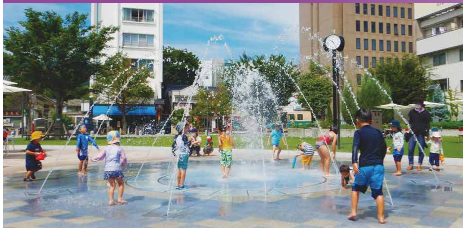
△ 噴水とじゃぶじゃぶ池を設計施工。中央に向かって二重のアーチ噴水が出ており、それぞれ高さが変化する。中央は干満型のじゃぶじゃぶ池と直上噴水がある。夜はライトアップされ、市民の憩いの場となっている。
