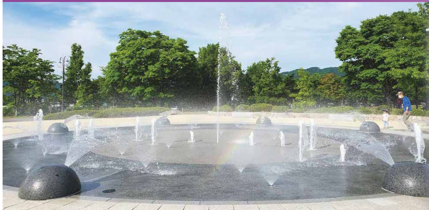
△ 噴水を設計施工。直上噴水・噴霧噴水・石からの扇型噴水と、バラエティのある噴水広場となっている。直上噴水は空気の泡を含んだエアフォーム噴水となっており、当たりが柔らかい。
