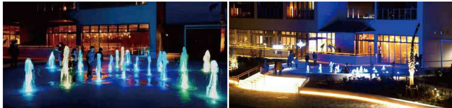
△ 木更津市のP-PFI事業において、噴水を設計施工。20本のエアフォーム噴水が個別のポンプで制御されており、タイマーで決まった時刻になると、自動で演出が始まる。夜はそれぞれの噴水がライトアップされ、夜景を美しく彩る。
