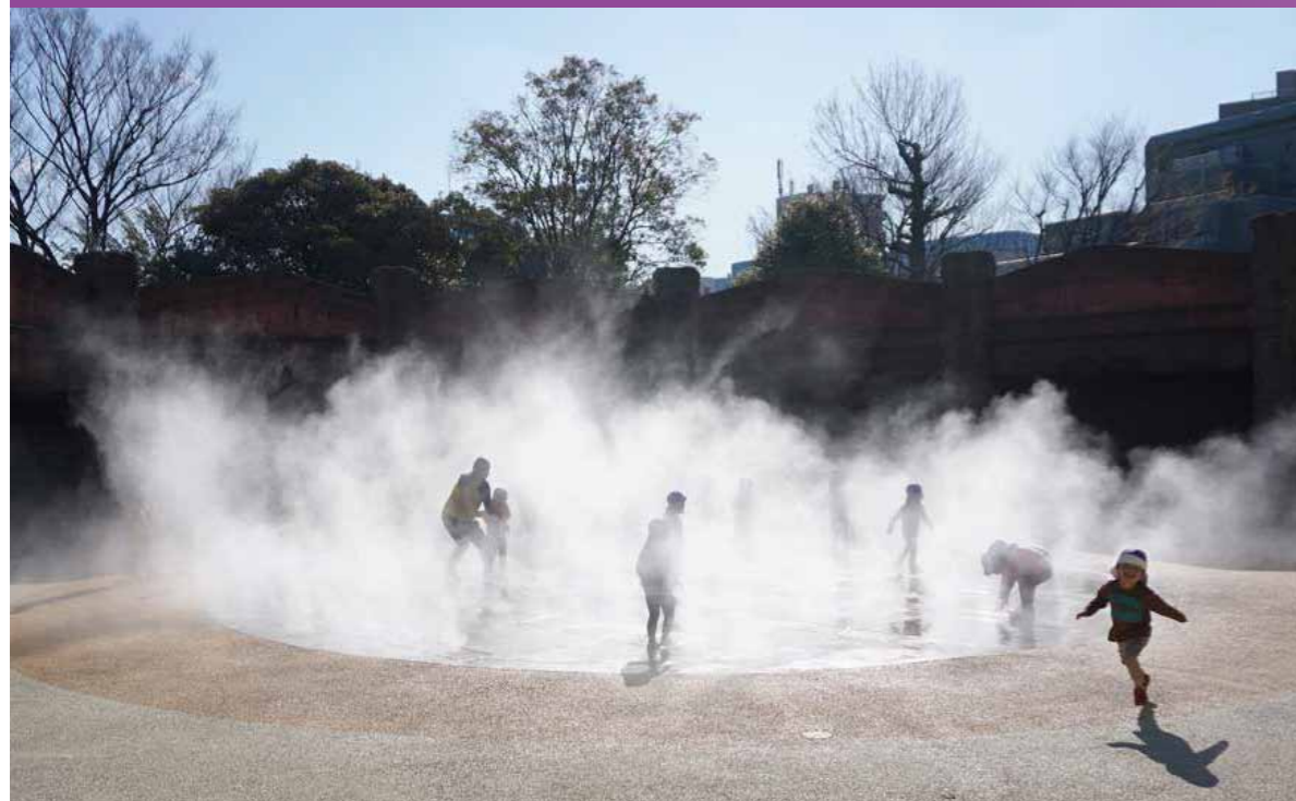
△ ミストを設計施工。噴霧量を変化できる設計になっており、季節にあった噴霧量の演出が自動で運転する。子どもたちは徐々に増えるミストの中を走り抜けて遊べる。気象センサーの追加により、その日の天気によって自動で運転を判断するため、管理も容易になっている。
