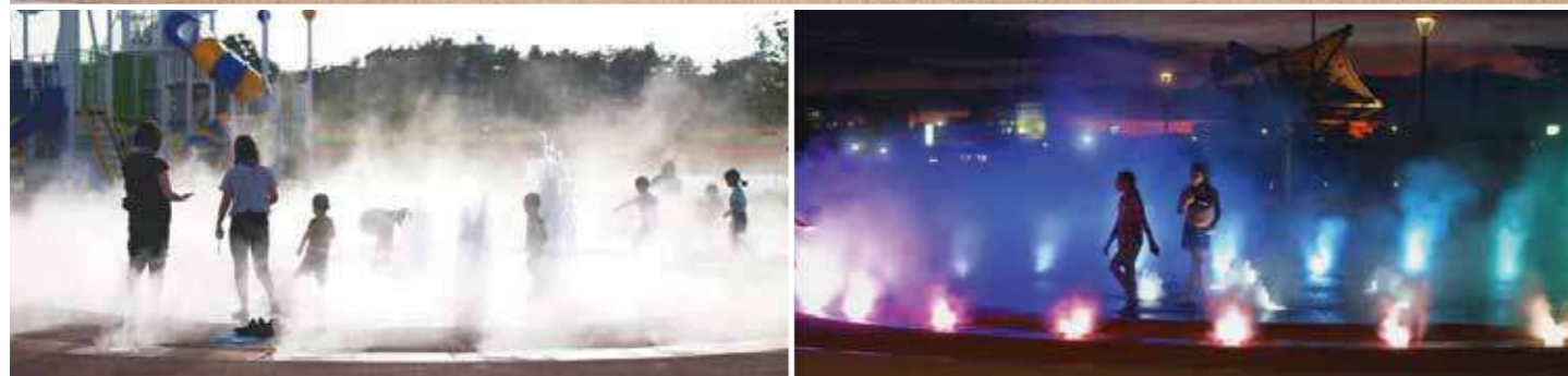
△ 噴水とミストを設計施工。迫力のある樹水噴水は、高さに変化する仕組み。空気を含んだ柔らかい噴水のため、小さな子どもでも安心して楽しめる。ミストは個々に制御されており、変化に富んで楽しめる広場。夜は噴水とミストがライトアップされる。
