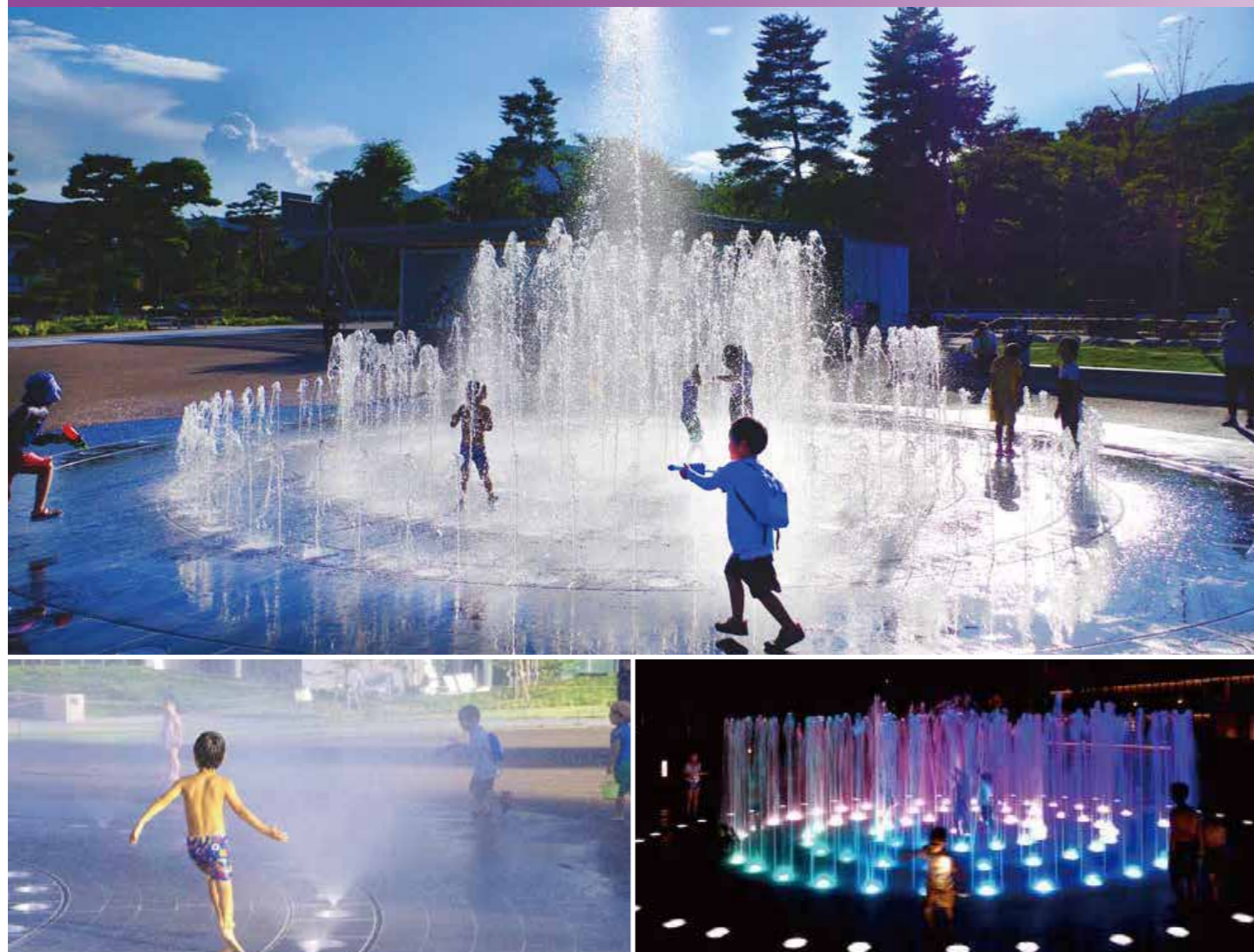
△ 噴水とじゃぶじゃぶ池を設計施工。153本もの直上噴水が水の壁を作り、間を通過して子どもたちが楽しむ。周囲には噴霧噴水、中央は干満システムのじゃぶじゃぶ池がある。夜は126灯の照明によって美しくライトアップされる。
